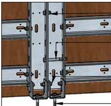
VERWENDUNG VON ZUSÄTZLICHEN M16X35 MM ZUGBOLZEN ZUR VERBINDUNG VON ALUMINIUMELEMENTEN
