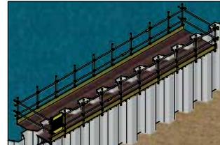
BEFESTIGEN SIE DAS SPERRHOLZ AN DER HALTERUNG, UM EINE ARBEITSBÜHNE/ LAIBUNG ZU KONSTRUIEREN, MONTIEREN SIE DANN DEN HANDLAUF.
