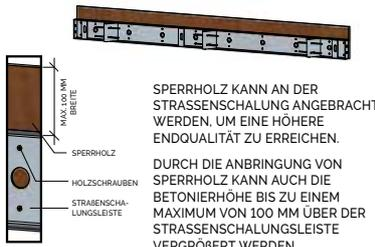
SPERRHOLZ KANN AN DER STRASSENSCHALUNG ANGEBRACHT WERDEN, UM EINE HÖHERE ENDQUALITÄT ZU ERREICHEN. DURCH DIE ANBRINGUNG VON SPERRHOLZ KANN AUCH DIE BETONIERHÖHE BIS ZU EINEM MAXIMUM VON 100 MM ÜBER DER STRASSENSCHALUNGSLEISTE VERGRÖßERT WERDEN.
