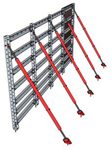
START FIXING THE PLYWOOD SECURING IT FROM BEHIND USING 25MM WOOD SCREWS. MAKE SURE THE PLYWOOD JOINTS FALL ON THE CENTRE OF THE UPRIGHTS OR THE HORIZONTAL JOINING MEMBERS.
